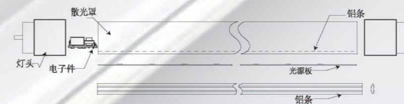
塑套铝灯管内部结构图
